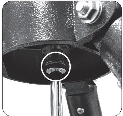
Bitte die beiden Unterlegscheiben (A) an angezeigter Stelle hinzufügen, damit die Montage fest auf dem Stativ montiert werden kann.
