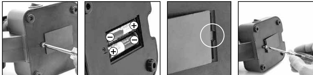
Para observação com a iluminação elétrica (6) precisa de inserir 2 pilhas AA de 1,5 V no compartimento das pilhas (8), na base do microscópio (7). O compartimento das pilhas pode ser aberto com uma chave Philips. Preste atenção à polaridade correta ao inserir as pilhas (indicação de +/-). A tampa do compartimento das pilhas deve ser inserido primeiro na pequena abertura à direita, para que a tampa encaixe corretamente. Depois pode então colocar o parafuso.
