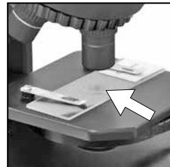
Voor de normale observatie zet je de microscoop op een goed verlichte plaats (raam, bureaulamp). Draai de scherpteregeling (2) tot aan de bovenste aanslag en stel de objectiefrevolver (3) op de kleinste vergroting in.
