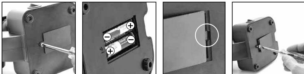
Per eseguire l'osservazione con l'ausilio della luce elettrica (6), inserire 2 batterie AA da 1,5 V nel vano batterie (8) nel piede del microscopio (7). Il vano batterie si apre con l'ausilio di un cacciavite a croce. Durante l'inserimento delle batterie, verificarne la corretta polarità (segno +/-). Il coperchio del vano batterie deve essere prima inserito a destra nella piccola apertura e adattato con precisione. A questo punto si può serrare la vite.
