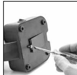
Om dingen te bekijken met het elektrische licht (6) heb je 2 AA batterijen van 1,5 V nodig, die in het batterijvak (8) in de voet van de microscoop (7) worden geplaatst. Het batterijvak dient met een kruiskopschroevendraaier geopend te worden. Let bij het plaatsen van de batterijen op de juiste polariteit (+/-). Het deksel van het batterijvak moet nu eerst rechts in de kleine opening gezet worden zodat het deksel precies past. Nu kun je het Schroefje aandraaien.
