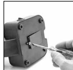
Для наблюдений с электронной подсветкой (6) вставьте 2 батарейки АА 1,5 В в батарейный отсек (8), расположенный в основании микроскопа (7). Батарейный отсек можно открыть с помощью крестовой отвертки. При установке батареек соблюдайте полярность (обозначена знаками +/-). Затем поставьте крышку батарейного отсека на место, сначала вдвинув выступ крышки в маленький паз, и закрутите винт.
