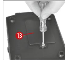
Батарейный отсек расположен в основании микроскопа (13). Ослабьте винт на крышке батарейного отсека с помощью
