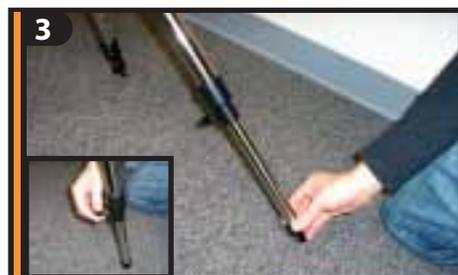
Опоры штатива выдвигаются на желаемую длину, регулируя высоту монтировки. Для этого ослабьте зажим винта фиксатора на каждой опоре, выдвиньте опоры на желаемую высоту.
