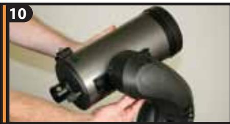
10 Прочно закрепите трубу на монтировке, вручную затянув зажимной винт.
