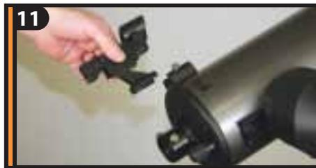
11 Для установки искателя, ослабьте крепежный винт на установочной платформе и вставьте в нее искатель, как показано выше на рисунке.
