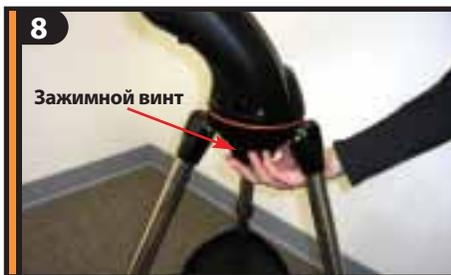
Закрутите зажимной винт в отверстие в нижней части основания монтировки и затените его вручную.
