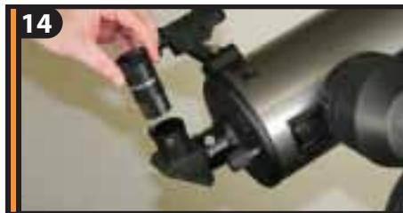
14 Вставьте хромированную посадочную втулку окуляра в диагональное зеркало и закрепите окуляр винтом фиксатором.
