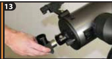
13 Ослабьте винты фиксаторов окулярного адаптера, а так же снимите крышку с адаптера. Установите диагональное зеркало и зафиксируйте его винтом.
