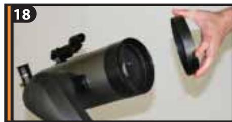
18 Прежде чем начать наблюдения не забудьте снять крышку объектива.
