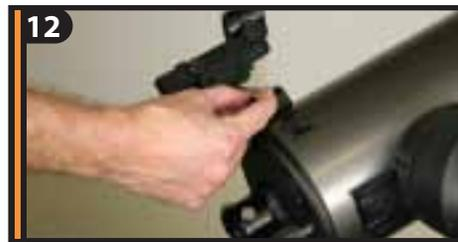
12 Зафиксируйте искатель, затянув крепежный винт.
