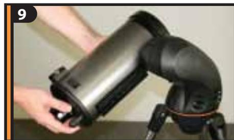
Вставьте крепежную планку оптической трубы в зажим вилочной монтировки, как показано на рисунке выше, при этом надпись на трубе не должна быть перевернута.
