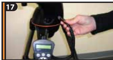
17 Вставьте его в гнездо порта "Hand Control", расположенное в основании монтировки телескопа так, чтобы он защелкнулся.
